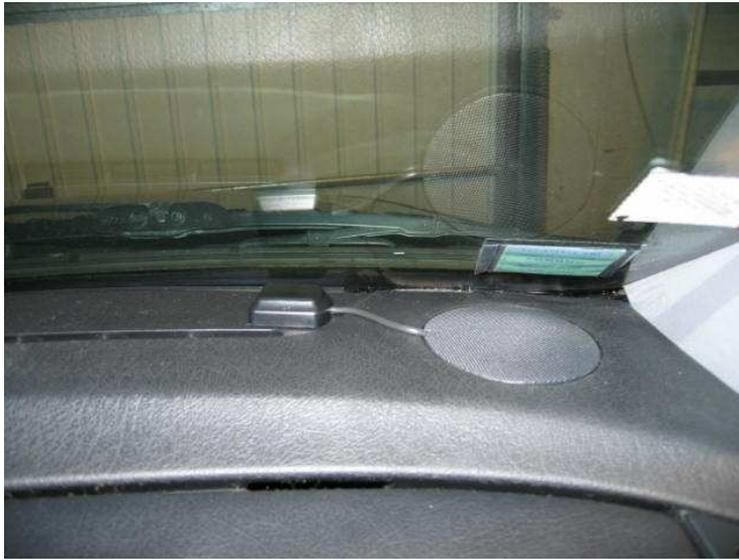
Même principe de l'aiguille pour remonter le cable jusqu'au GPS.
