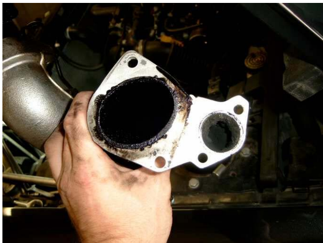
La sortie de la vanne EGR:
