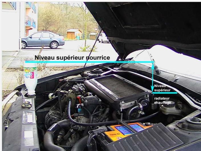
Dans un premier temps, le remplissage se fait de manière "statique", moteur à l'arrêt, il faut remplir la nourrice et maintenir son niveau en ouvrant successivement les 3 vis de purge du circuit jusqu'à ce qu'il n'y ait plus d'air qui sorte de chaque vis de purge, la première étant sur le radiateur de refroidissement moteur, la seconde sur un tuyau dans le moteur et la dernière sur le radiateur de chauffage:
