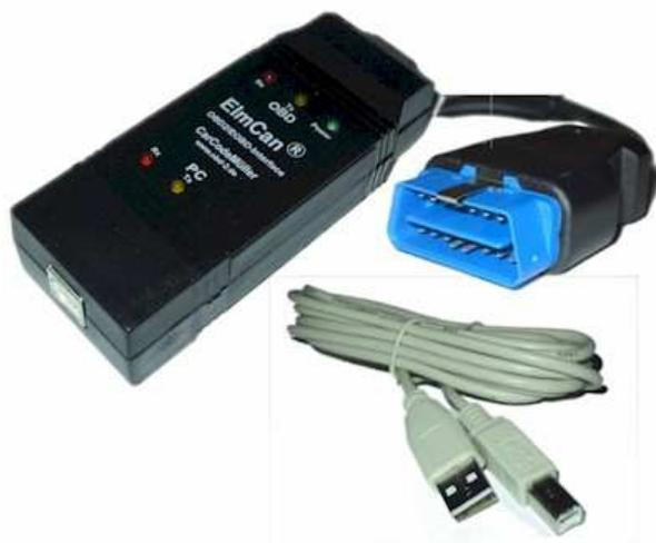
C'est une interface diagnostic ELM 327 MULTIPROTOCOL en modèle USB
