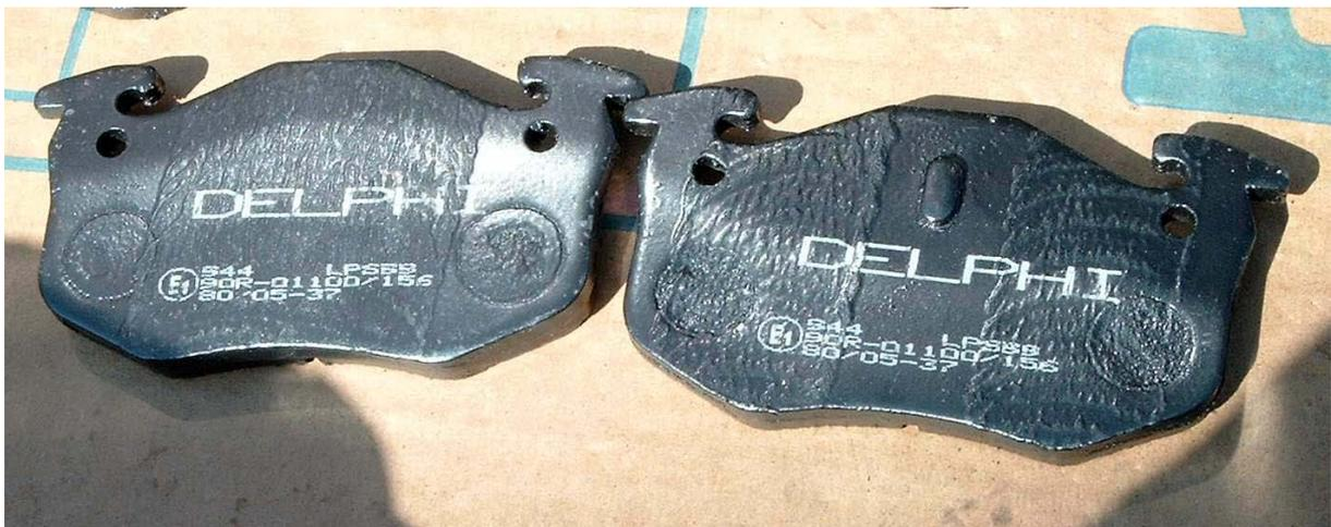
Celle de droite comporte un ergot destiné à se loger dans le piston, assurant ainsi le fonctionnement du dispositif de rattrapage.
