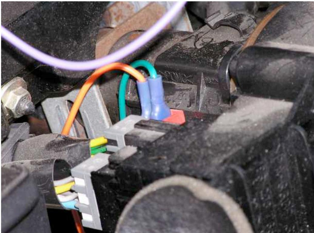
Puis disposer le boîtier, à gauche de la boîte à fusible. Pour l'instant je laisse du mou pour travailler à l'aise. A cet emplacement il est proche de la broche d'alimentation, mais aussi du trou dans le tablier par où va passer le câble qui alimente le servomoteur (et puis de toute façon je n'ai pas beaucoup de choix, de l'autre côté il n'y pas de place, même pas de vraie boîte à gants pour cause de clim).
