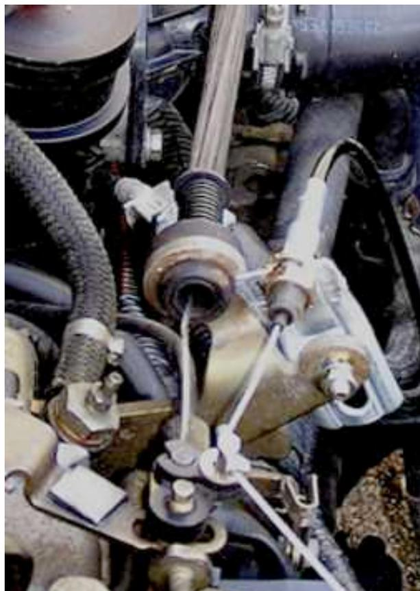
Une simple patte vissée à coté du câble d'origine, le serre-câble et voilà.
