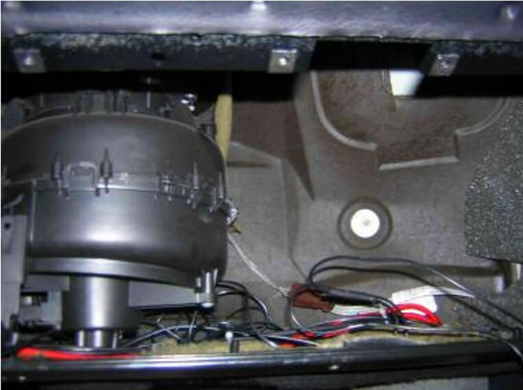
10. Découpez la surface de protection proprement au cutter, percez un passage vers le compartiment moteur. Protéger de la rouille et mettez un passe câble.
