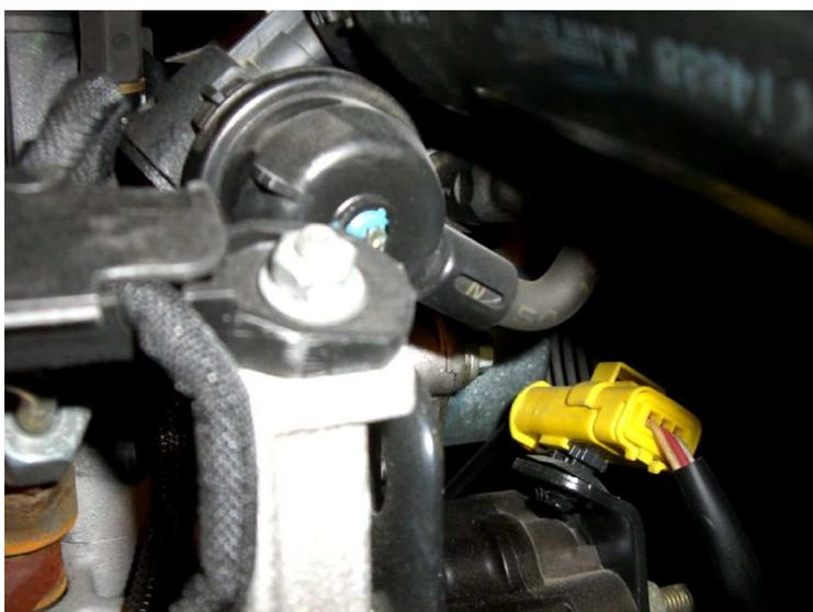
Si je ne me trompe pas, vu comment pars la durite (celle du bas), on dirait que c'est celle de commande l'EGR (cf schéma en bas).
