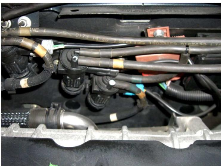
La seconde entrée de la seconde électrovanne a l'air de partir vers le bas, si je suis le schéma, ça doit aller sur le turbo.
