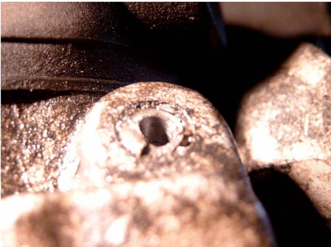
Une fois cette étape faite, il faut assurer le guidage des prochains forets. Pour ce faire, l'idéal est d'utiliser un foret à centrer, personnellement j'utilise un 3x12. Le 3mm m'assure le centrage, et le cône de coupe m'assure un cône à 85°, idéal pour guider les prochaines passes.
