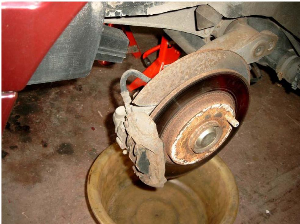
Dévisser les 2 vis de fixation de l'étrier (19), mais auparavant débloquer les 2 vis de fixation de la pince sur le mécanisme du piston (17)
