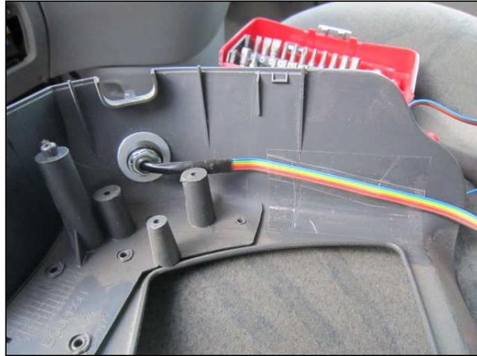
Pour permettre le passage de la trame de cette commande dans le trou Ø10mm, l'extrémité de cette dernière n'est pas reliée au connecteur.
