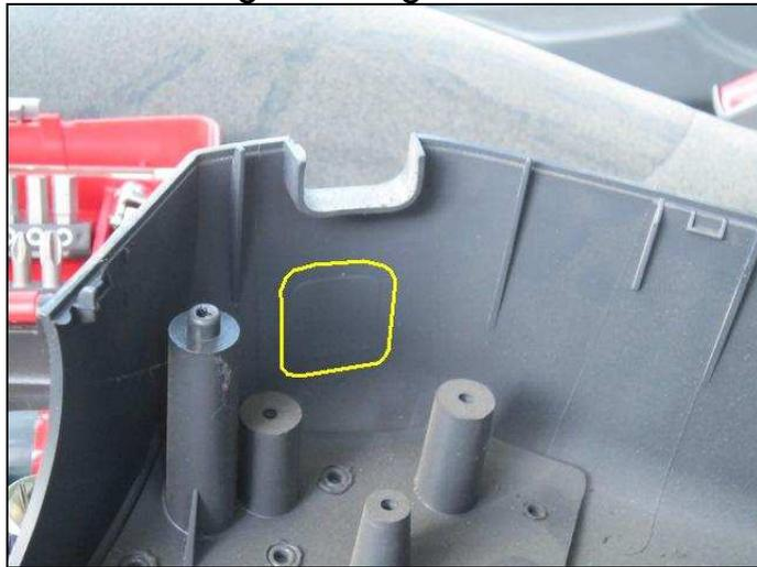
J'ai donc percé en plein milieu de ce « carré » à  $\varnothing 10\text{mm}$ . J'ai ensuite formé une rondelle carrossier de  $\varnothing 10\text{mm}$  pour épouser la forme interne du cache. Cela me procure une assise rigide et solide :
