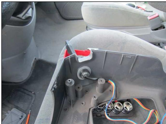
Il faut régler les rondelles plastiques biseautées afin d'obtenir l'angle désiré pour la commande. J'ai repositionné le cache, réglé et serré. Ainsi, j'ai le même angle que le commodo d'origine.
